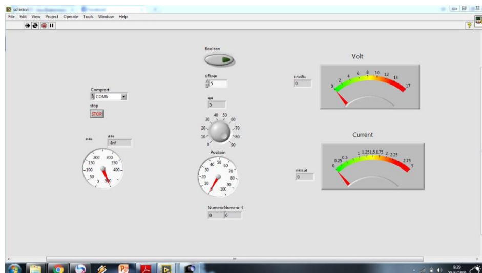
ภาพที่ 3 หน้าต่างโปรแกรม Labview ควบคุมการทำงานของชุดสาธิตพลังงานแสงอาทิตย์
